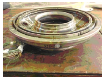
Рис. 1. Общий вид ЩУ до выполнения экспериментальных испытаний на изделии АИ-336-6,3
