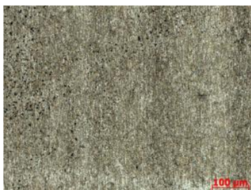
Рис. 3. Микроструктура образца из стали 40X10C2M до обработки
