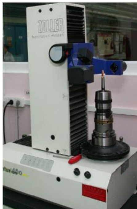
Рис. 2. Микроскоп Zoller для настройки осевого инструмента
