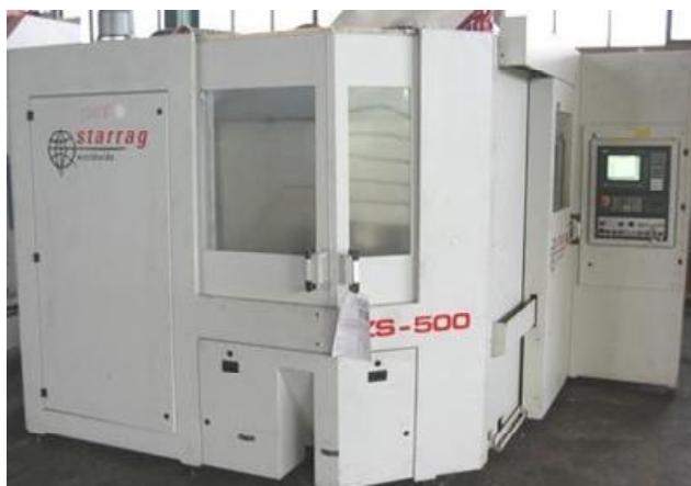
Рис. 3. Универсальный обрабатывающий центр Starrag ZS 500/130
