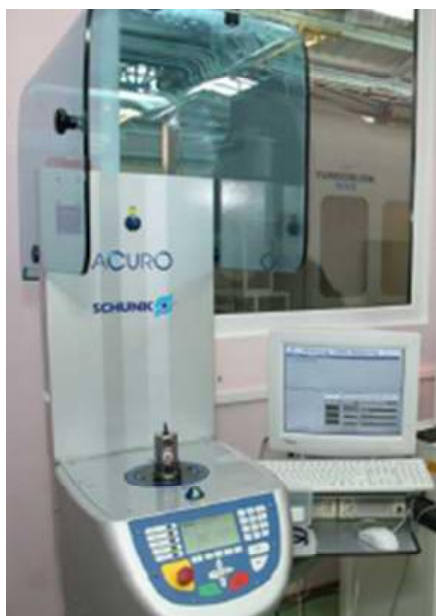
Рис. 1. Балансировочный станок Acuro фирмы Schunk
