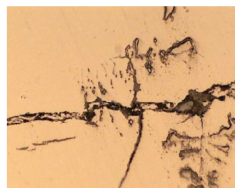
Рис. 3. Вид микротрещины на острие развития
