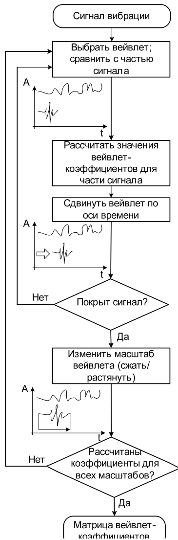
Рис. 1. Алгоритм непрерывного вейвлет-преобразования
