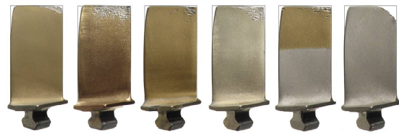
Рис. 4. Лопатки 6 ст., прошедшие эрозионные испытания
