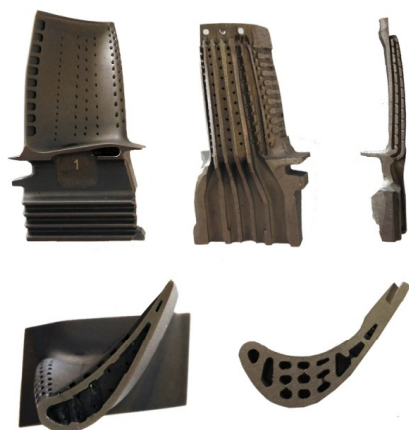
Рис. 7. Стержень рабочей лопатки с внутрискребочным охлаждением
