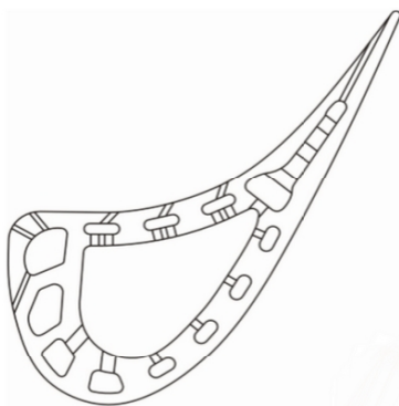
Рис. 2. Сечение рабочей лопатки, предложенной в работе Дэйли
