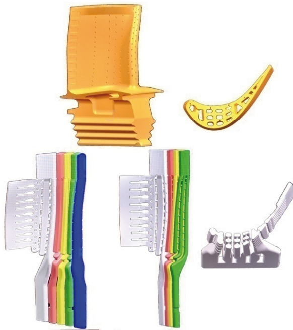
Рис. 5. Твердотельная модель спроектированной лопатки и стержня
