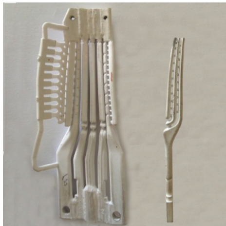
Рис. 7. Стержень рабочей лопатки с внутрискребочным охлаждением
