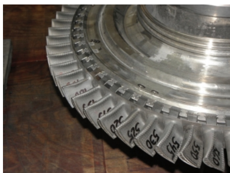
Рис. 8. Рабочая лопатка с внутрискребочным охлаждением
