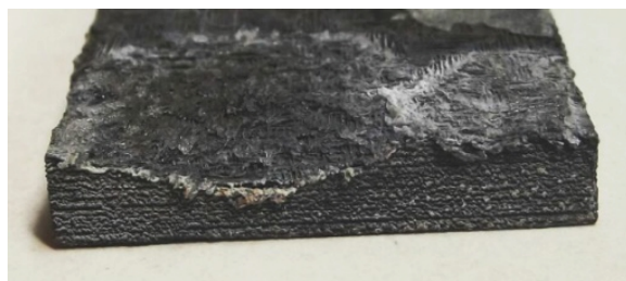
Рис. 10. Внешний вид образца УУКМ-подложки после термоэрозионных испытаний в продуктах сгорания в кислороде в серии 03E
