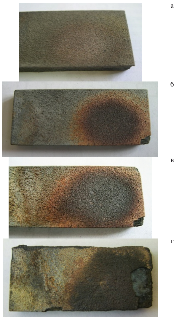
Рис. 4. Внешний вид поверхности в области пятна нагрева образца №02 после термоэрозионных испытаний серии 02А: а – после испытания 02А3; б – 02А5; в – 02А6; г – 02А8
