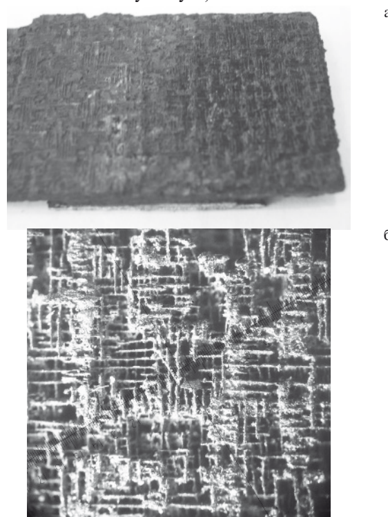
Рис. 7. Внешний вид поверхности образца №04 после испытаний серии 04С: а – после испытания 04С2; б – то же увеличено (ширина поля – 7,5 мм)
