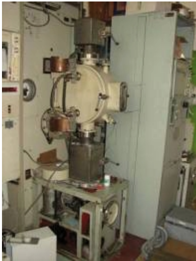
Рис. 9. Оборудование для механических испытаний в вакууме: «NIKON» 1246
