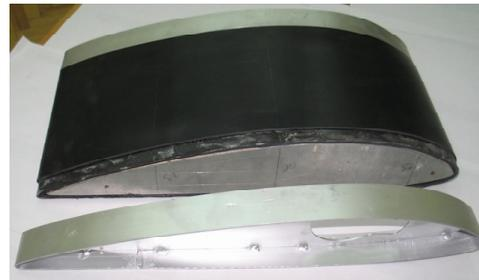
Рис. 2. Лопасть с гибкими элементами и нервюра
