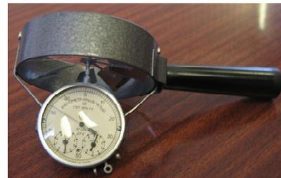
Анемометр крыльчатый АСО-3
