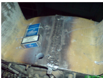
Рис. 4. Элемент корпуса компрессора низкого давления авиадвигателя Д-36 после заварки восстановленных участков
