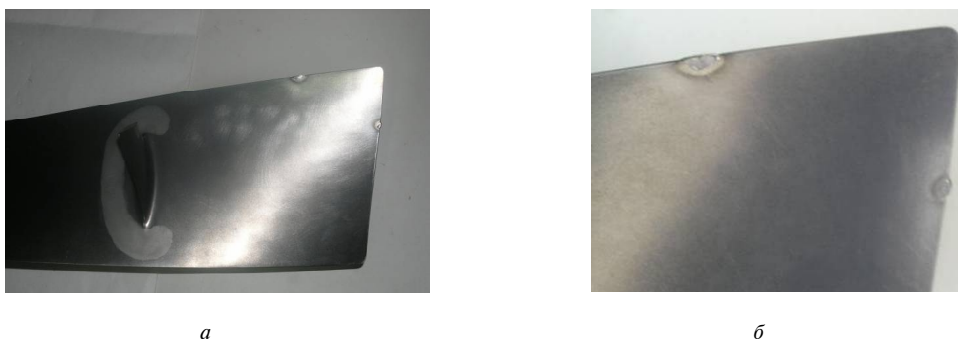
Рис. 2. Вид лопатки после заварки забоины АДС:
