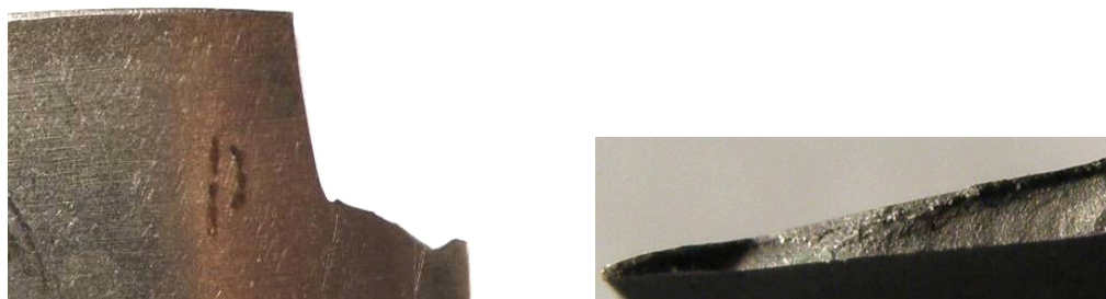
Рис. 4. Характерный вид разрушения лопаток после испытаний по четвертой изгибной форме
