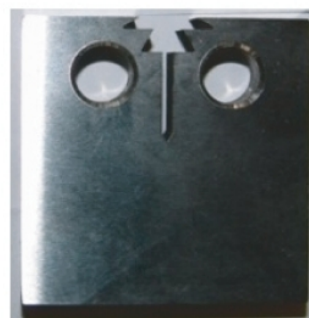
Рис. 1. Компактный СТ-образец для испытаний на СРТУ
