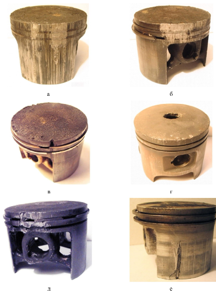
Рис. 1. Основные виды повреждений поршней из сплава АЛ25:
