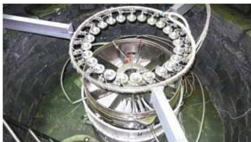
Рис. 6. Корпус двигателя с подготовленной лопаткой на разгонном стенде
