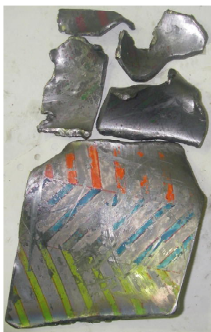
Рис. 8. Разрушенная лопатка после обрыва
