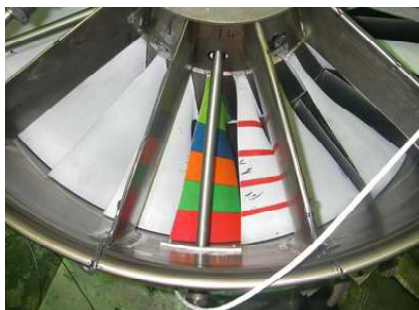
Рис. 5. Корпус двигателя с подготовленной лопаткой
