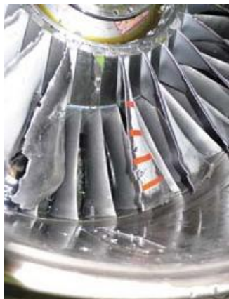
Рис. 7. Ротор вентилятора после испытаний
