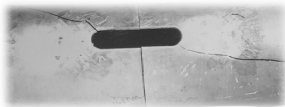
Рис. 1. Усталостное разрушение вала верхнего несущего винта
