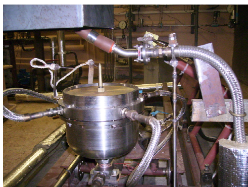
Рис.1. Фотографии стенда Ц-17ГЗ в состоянии готовности к огневым испытаниям: а - гибкого трубопровода; б - жесткого трубопровода
