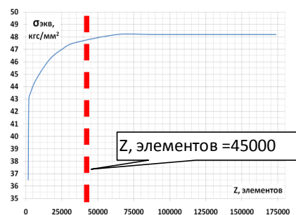
Рис. 7. Зависимость максимальных эквивалентных напряжений в зоне А от Z , элементов
