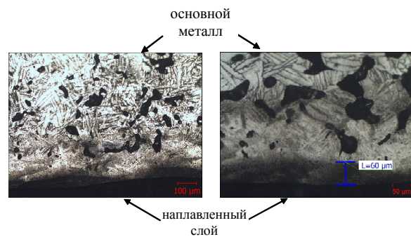
Рис. 4. Микроструктура основного материала и наплавленного слоя толщиной 50–100 мкм
