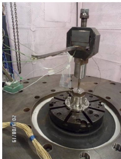
Рис. 2. Устройство для исследования теплопроводности материалов в поле действия виброускорений
