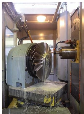
Рис. 10. Рабочая зона модернизированного 5-координатного станка ИС-800
