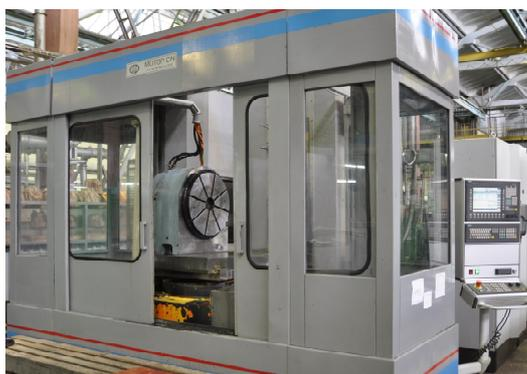
Рис. 9. Модернизированный 5-координатный станок ИС-800 с системой ЧПУ SINUMERIK-840D
