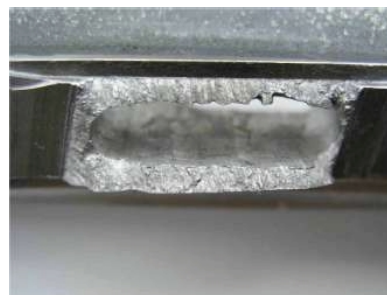
Рис. 14. Поверхность обрыва в среднем сечении разрушенной лопатки
