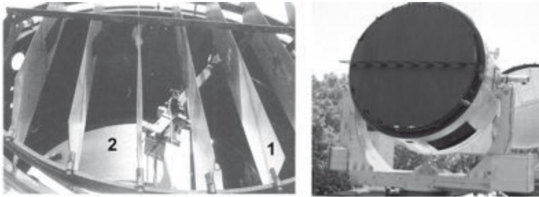
Рис. 1. Гелиоустановка, на которой проводилось исследование термокинетики реакционного взаимодействия при получении сплава на основе ниобия: 1 – жалюзи; 2 – параболическое зеркало \varnothing 2 м
